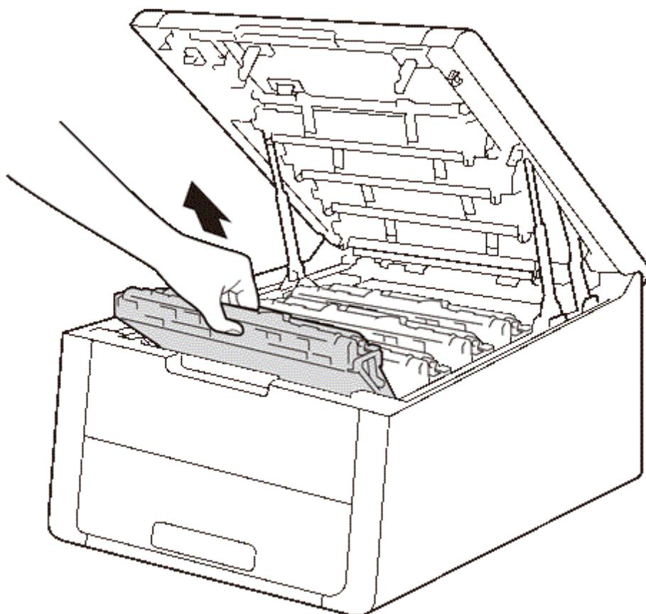
4. Нажмите вниз на зелёный рычаг фиксатора и извлеките тонер-картридж из фотобарабана.
