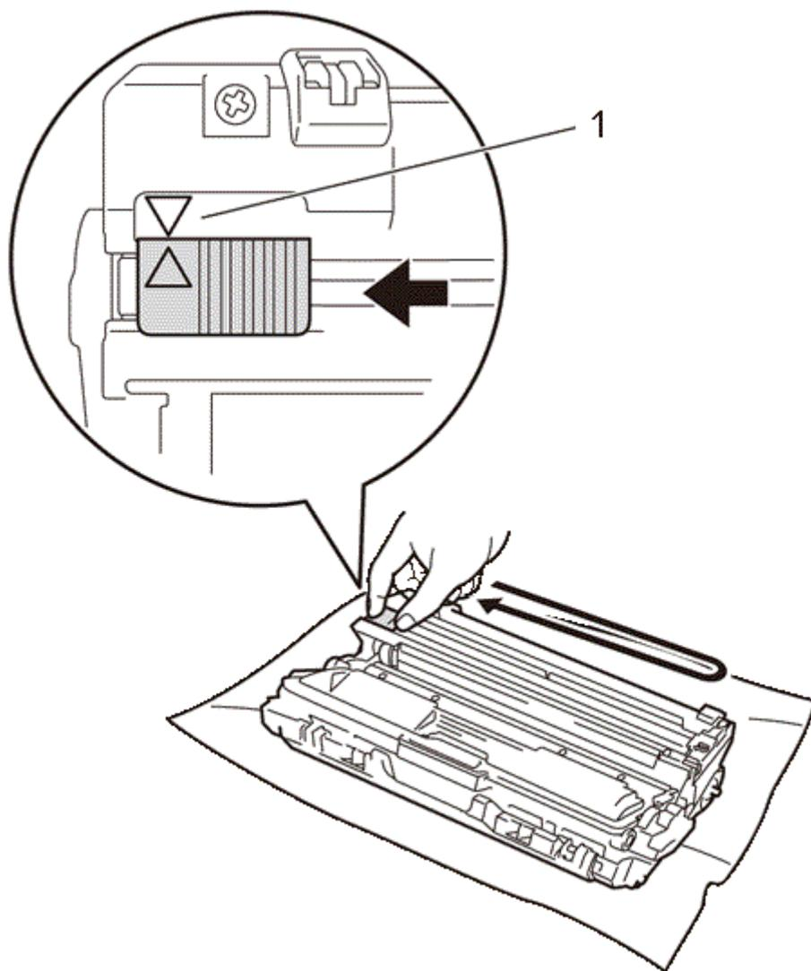
Обязательно верните ползунок в исходное положение (▲) (1). Стрелка на ползунке должна быть на одной линии со стрелкой на фотобарабане. В противном случае на напечатанных страницах может появиться вертикальная полоса.
