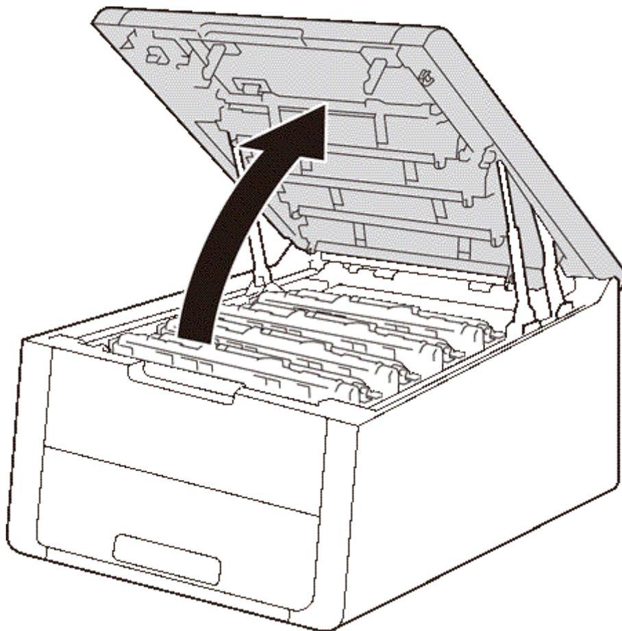
3. Извлеките узел фотобарабана и тонер-картриджа того цвета, который указан на дисплее.
