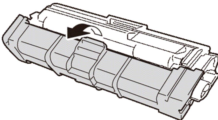
7. Вставьте новый тонер-картридж в фотобарабан так, чтобы он зафиксировался на месте со щелчком. При правильной установке зеленый рычаг блокировки фотобарабана автоматически поднимется.
