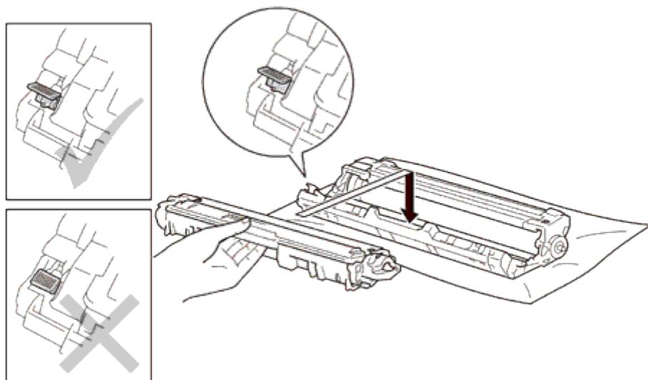
8. Очистите коронирующий провод внутри фотобарабана, осторожно подвигав зелёный ползунок слева направо и справа налево несколько раз.
