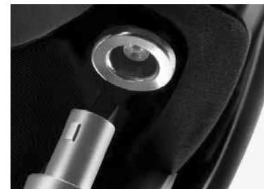
ODU-kontakter med hög precision säkerställer stabil signalöverföring och flexibla uppkopplingsmöjligheter.
